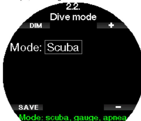
NOTE : puisque les modes Profondimètre et Apnée ne suivent pas la saturation des tissus, un intervalle de blocage de 48 heures s'initialise entre le moment où la dernière plongée en mode Profondimètre ou Apnée est effectuée, et celui où un changement pour le mode plongée Scuba est possible. Inversement, le Galileo 3 présenté ci-dessous a été utilisé en mode plongée Scuba et ne peut pas passer en mode Profondimètre ou Apnée tant que la durée de désaturation n'est pas terminée.
