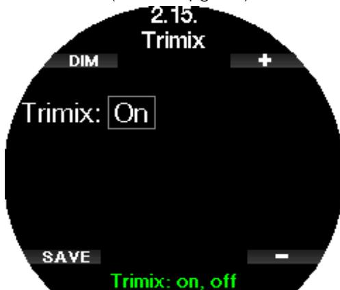
Lorsque le Trimix est sélectionné, la présentation du contenu des gaz suit l'usage pour O<sub>2</sub>/He. De même, la profondeur minimale absolue AMD pour chacun des gaz est affichée. Consultez le chapitre **Plonger en mode Trimix** pour en savoir plus la façon d'utiliser cette fonction.
