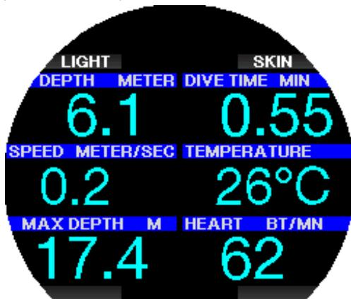
Une pression sur le bouton SKIN permet de faire afficher la température mesurée par la ceinture cardiofréquence-mètre sur la fenêtre de la fréquence cardiaque.
