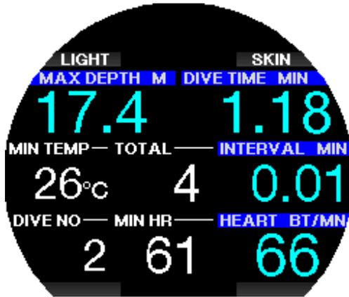
Au cours de la plongée, le mode Apnée affiche la profondeur actuelle, le temps en plongée, la vitesse de remontée ou de descente, la profondeur maximale, et la fréquence cardiaque.
