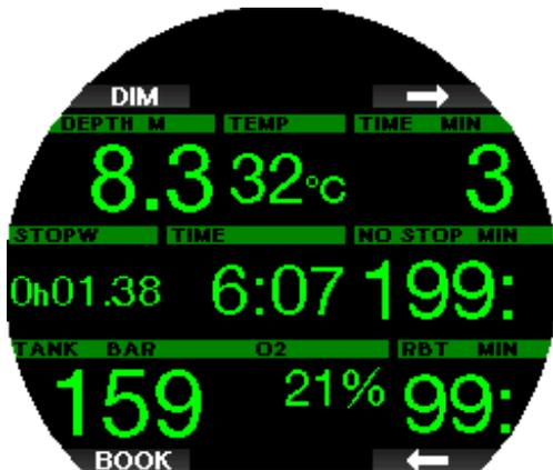
Réinitialiser le chronomètre génère un signet qui apparaîtra sur le profil de plongée dans le logiciel LogTRAK.
