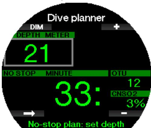
la profondeur minimale pour une planification est de 9 m (30 pieds). Le planificateur ne permet d'utiliser que des profondeurs qui respectent la PPO<sub>2</sub> max. La part d'oxygène du mélange et les réglages de la PPO<sub>2</sub> max sont indiqués dans le menu 1 . **Réglage O<sub>2</sub>** (O<sub>2</sub> setting).
