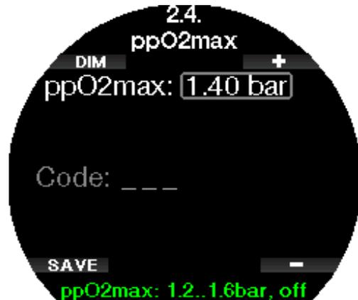
Dans ce menu, il est également possible de désactiver le réglage de la MOD. Cela exige d'indiquer le code de sécurité 313.
