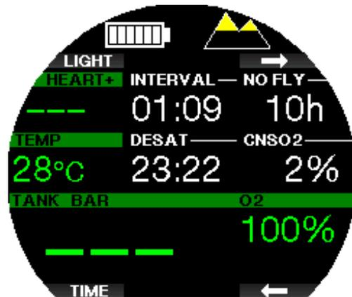
Les altitudes autorisées sont indiquées avec un symbole de montagne dans le coin en haut à droite de l'affichage des paramètres de plongée actuels. Les plages d'altitude interdites (que le Galileo 3 a calculées comme étant incompatibles avec vos niveaux actuels de saturation en azote) sont représentées par des segments colorés à l'intérieur du symbole de montagne. Pour plus de détails, consultez le chapitre Altitude et algorithme de décompression.
