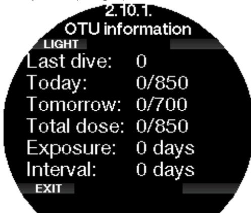
Les OTU sont calculées par jour, changent à minuit (00:00) et les limites changent en fonction de cela. Vous pouvez définir l'intervalle de réinitialisation, qui est la durée passée sans enregistrer de plongée nécessaire pour que le compteur d'OTU revienne à zéro.
