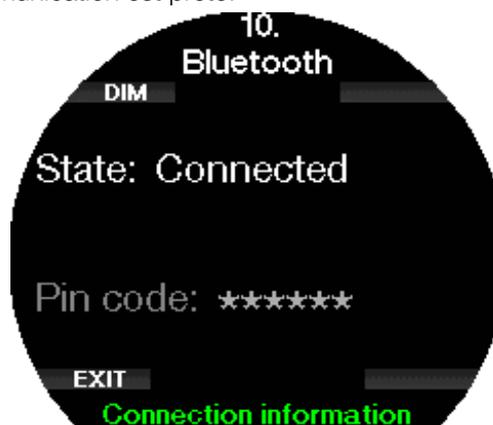
☞ *NOTE : la connexion Bluetooth expire au bout de 3 minutes si elle n'est pas active avec le Galileo 3. Après cet intervalle, le Galileo 3 désactive Bluetooth et revient à l'écran au menu Montre afin d'économiser de l'énergie.*
