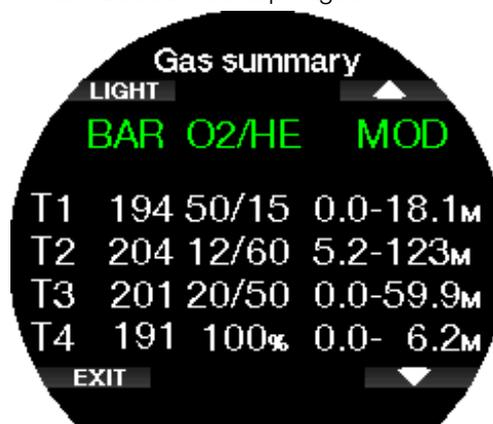
☞ **NOTE** : l'émetteur Smart communique le signal de pression seulement pour le bloc actuellement utilisé. Lorsque le bloc n'est pas utilisé pendant 5 minutes, l'émetteur se met en mode économie d'énergie, et la mise à jour du tableau résumé des gaz peut prendre plus longtemps.
