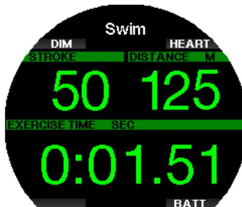
Une pression sur BATT fera afficher l'état de la batterie dans le coin en haut à gauche de l'écran.
