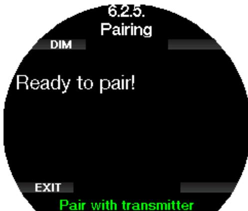
Lors de la mise en pression, l'émetteur Smart envoie une séquence d'appairage au Galileo 3. Lorsque le Galileo 3 reçoit cette information, l'affichage change pour montrer une liste de blocs. (**T1**, **T2**, etc.)
