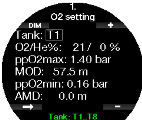
☞ **NOTE** : afin de garantir un apport adéquat en oxygène dans le corps, le gaz utilisé au début de la plongée doit contenir suffisamment d'oxygène (vous pouvez utiliser un mélange de progression ou l'un des gaz de décompression). Puisque la plongée commence toujours avec le bloc T1, la proportion minimale de O<sub>2</sub> dans le bloc T1 est de 18 %.
