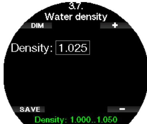
La densité de l'eau, cependant, dépend de la salinité, et donc à la même profondeur dans un lac (eau douce) et dans l'océan (eau salée), la mesure de la pression sera différente.
