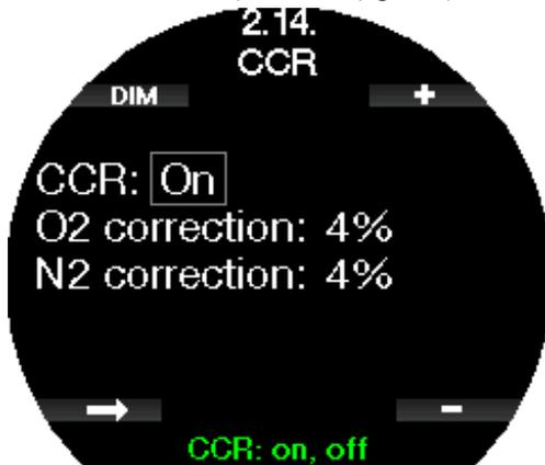
L'activation du mode CCR modifie les réglages par défaut du mode circuit ouvert pour passer à un mode par points de réglage. L'affichage en plongée sera également modifié de manière à ce que les pressions de O<sub>2</sub> et du diluant dans le bloc soient affichées simultanément. Consultez le chapitre **Configuration de l'affichage en mode CCR (recycleur à circuit fermé)** pour en savoir plus sur la manière dont l'affichage est configuré dans ce mode.
