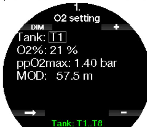
T1 est toujours le gaz par défaut au début de la plongée. Les valeurs des blocs 2 à 8 sont réglables de la même façon que celle du bloc 1. Vous pouvez indiquer une valeur de ppO<sub>2</sub> différente pour les gaz de décompression.
