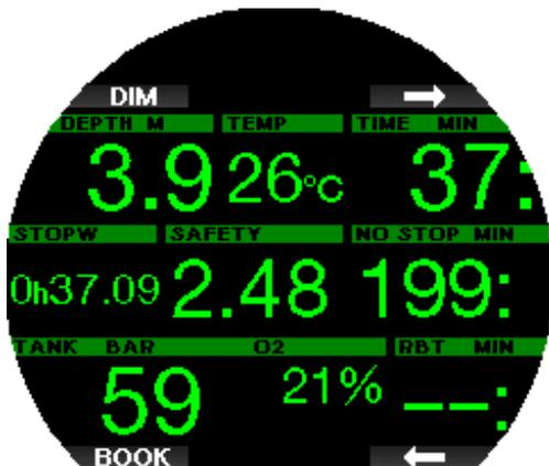
Lorsqu'il est affiché, le compte à rebours de palier de sécurité peut être arrêté par une pression sur le bouton TIMER.
