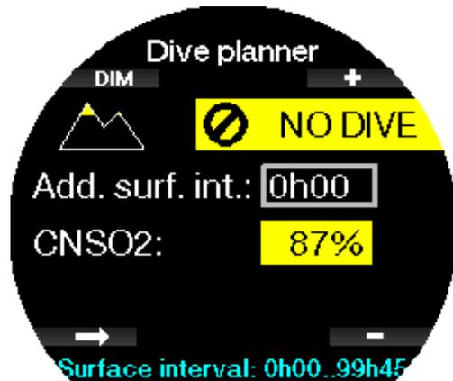
Le compteur de CNS  $O_2$  augmente lorsque la pression partielle d'oxygène est supérieure à 0,5 bar, et diminue lorsque la pression partielle d'oxygène est inférieure à 0,5 bar. Par conséquent, lorsque vous respirez de l'air en surface vous diminuerez toujours le compteur de CNS  $O_2$ . Pendant la plongée, la profondeur à laquelle 0,5 bar est atteint pour les différents mélanges gazeux est la suivante :
