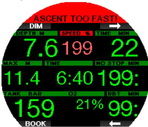
Le Galileo 3 déclenche aussi une alarme sonore en cas de vitesse de remontée dépassant 110 % : l'intensité de l'alarme augmente proportionnellement au degré de dépassement de la vitesse idéale de remontée.
