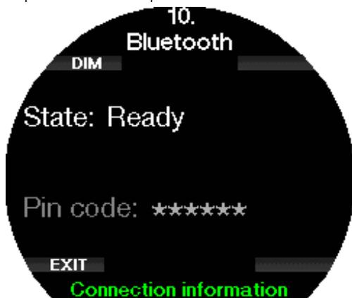
Pour établir une connexion Bluetooth avec un autre appareil, mettez cet appareil (par exemple un appareil mobile iOS® ou Android) en mode « scan ». La première fois, cela exigera d'entrer un code de sécurité pour garantir que la communication est sécurisée. Le code de sécurité est généré de manière aléatoire par votre Galileo 3 et s'affiche sur son écran.
