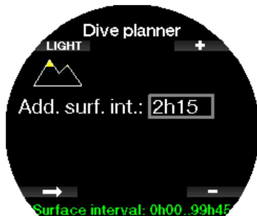
L'altitude interdite est visualisée avec le symbole de montagne, dont le pic ne doit pas être atteint par le plongeur. Pour plus d'informations sur la plongée en altitude avec le Galileo 3, consultez le chapitre : **Plongée en altitude**.
