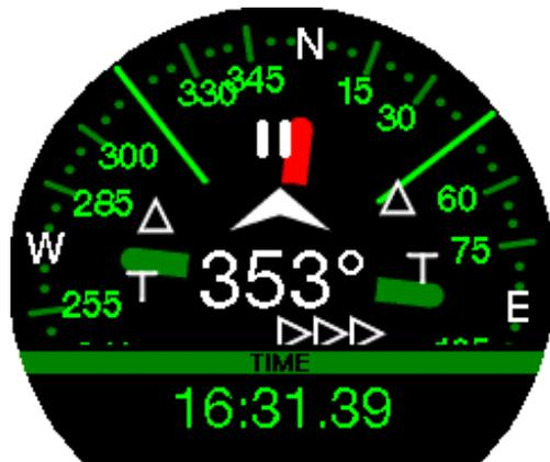
☞ **NOTE** : n'utilisez pas le compas du Galileo 3 à proximité d'un aimant, puisque la force magnétique pourrait obliger le calibrage du compas à se réinitialiser.
