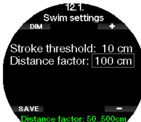
Pour le compteur de battements, vous devez régler le seuil de battement (quelle différence de profondeur est comptée comme un cycle de mouvement) et la distance parcourue lors de chaque cycle, afin d'obtenir un résultat correct.
