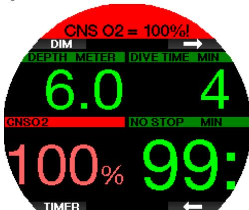
Le signal sonore se répète pendant 5 secondes à des intervalles de 1 minute, après sa première apparition, et ce tant que la valeur de la CNS O<sub>2</sub> reste à 100 % ou au-dessus, ou jusqu'à ce que la ppO<sub>2</sub> chute au-dessous de 0,5 bar (voir le chapitre **Plonger avec des mélanges nitrox** pour une liste des profondeurs auxquelles la ppO<sub>2</sub> est égale à 0,5 bar pour mélanges Nitrox particuliers).
