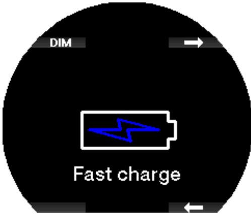
☞ NOTE : si la batterie du Galileo 3 est entièrement déchargée, rien ne s'affichera sur l'appareil jusqu'à ce que le niveau atteigne un niveau suffisant pour un démarrage. Si cela se produit, ne débranchez pas le câble USB et n'essayez pas d'allumer le Galileo 3 en appuyant sur un bouton. Laissez-le simplement charger pendant au moins une demi-heure.
