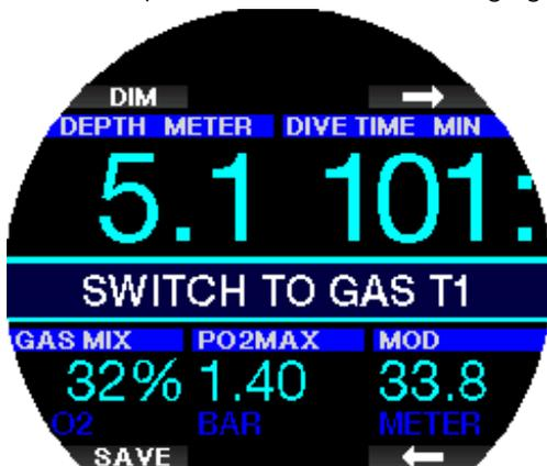
Le Galileo 3 va afficher le texte « **PASSAGE GAZ T1 RÉUSSI** » (Switch to gas T1 successful) et adapter le programme de décompression en conséquence.
