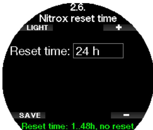
Le temps de réinitialisation peut être fixé entre 1 heure et 48 heures, ou sinon le temps de remise à zéro Nitrox peut être désactivé. La durée de réinitialisation des gaz est désactivée lorsque « pas RAZ » (No reset) s'affiche.
