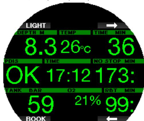
2. Vous êtes descendu(e) de plus de 0,5 m (2 pieds) en dessous du niveau du palier PDI. Le compte à rebours disparaît, et réapparaît en commençant à 2 minutes lorsque vous remontez à la profondeur du palier PDI.
