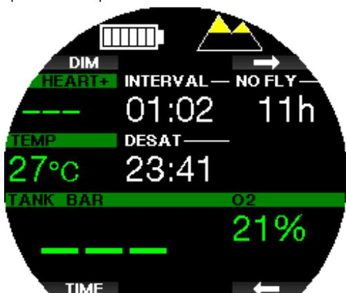
Les plages d'altitude interdites sont affichées par des segments jaunes à l'intérieur de l'icône de montagne. Cela peut être combiné avec les segments gris qui indiquent l'altitude actuelle. Dans l'exemple ci-dessus, le plongeur est actuellement la classe 1 d'altitude, et ne devrait pas atteindre les altitudes situées en classe 4 ou supérieures.
