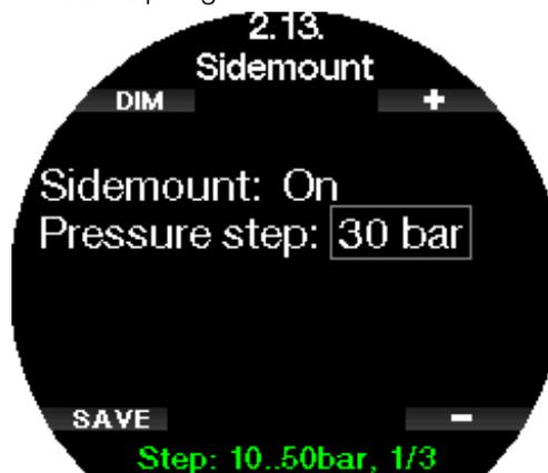
Lorsque le mode Sidemount du Galileo 3 est activé (ON), deux pressions de bloc sont affichées simultanément. Consultez le chapitre **Configuration de l'affichage en mode Sidemount** pour en savoir plus sur la manière dont l'affichage est configuré dans ce mode.
