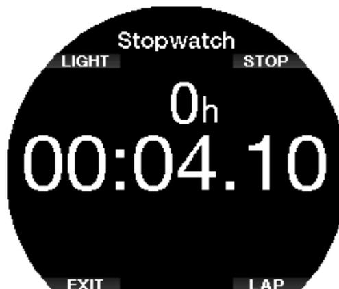
LAP vous permet de faire défiler les tours mesurés par le chronomètre. LAP n'est actif que lorsque le temps est décompté.
