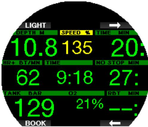
Pour des vitesses de remontée dépassant 140 %, l'alarme **REMONTÉE TROP RAPIDE! (Ascent too fast!)** s'active, et la fenêtre de vitesse de remontée devient rouge.
