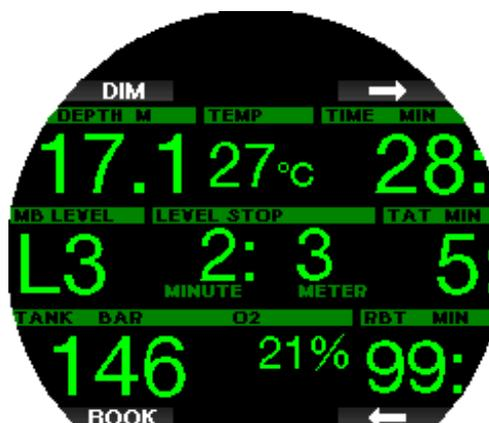
Une pression longue du bouton en haut à droite fait s'afficher le tableau résumé des gaz. Une pression sur le bouton en haut à droite fait afficher les paliers de décompression prévus, avec tous les gaz activés utilisés (PMG) et avec seul le gaz actuel qui serait utilisé (1G). Les niveaux des paliers de MB ou FG actuellement sélectionnés ainsi que les prévisions MB-level 0 ou FG 100/100 sont également affichés.
