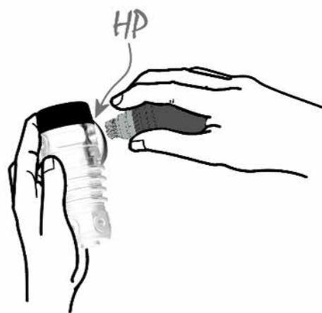
NOTE : utilisez une clé adaptée pour serrer l'émetteur. Faites bien attention à ne pas serrer exagérément.
