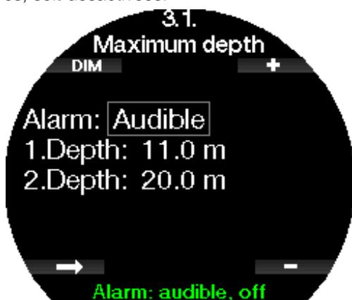
Après avoir activé l'alarme de profondeur maximale, les limites peuvent être sélectionnées. Les deux alarmes de profondeur peuvent être réglées entre 5 m et 100 mètres (20 à 330 pieds) par incréments de 1 m (5 pieds).
