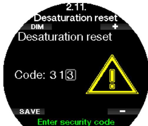
Lorsque le code de sécurité est indiqué correctement, et confirmé par une pression sur le bouton SAVE, la réinitialisation de la désaturation est effective, et l'écran suivant s'affichera.
