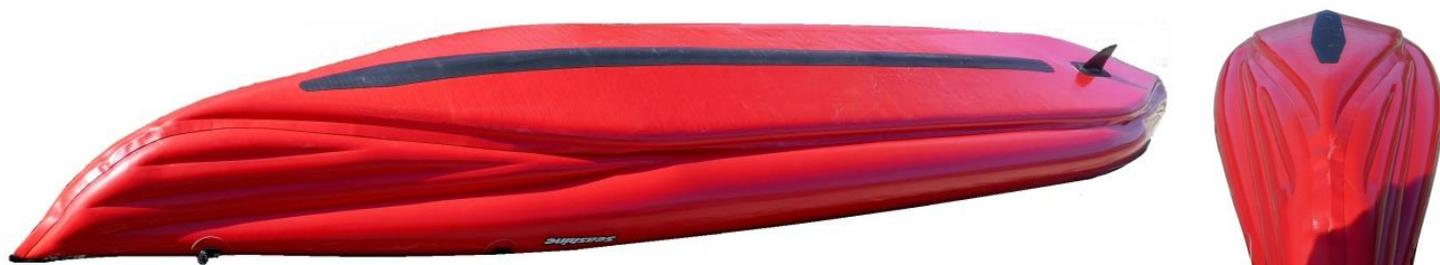
Le **GIRON** du Seashine est modifié par le fait que le fond-Dropstitch forme un « V » : ça augmente la hauteur du bateau uniquement sous une section de la coque d'environ 250 cm, légèrement décentrée vers l'avant. L'effet de cette forme particulière est direct : nous avons constaté que le bateau tourne un peu moins facilement que le modèle Seawave, et ne dérape pas de l'avant. Equipé avec la dérive arrière, l'effet « essuie-glace » est totalement neutralisé.
