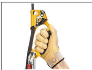
Les poignées bi-matière surmoulées disposent d'un ergot de calage pour l'index et d'une large zone d'appui inférieure pour empêcher que la main ne glisse. Cette géométrie assure une prise en main confortable, ainsi qu'une préhension puissante qui permet d'accroître l'efficacité de la remontée sur corde.
