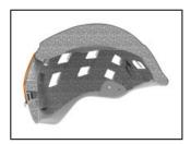
Construction In-Mold, avec un calotin en mousse EPS injecté sous une fine coque en polycarbonate, favorisant la compacité sur la tête.
